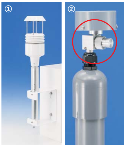
① 기상계 (풍향, 풍속, 온도, 습도) ② PM2.5 Cyclone 분립장치
